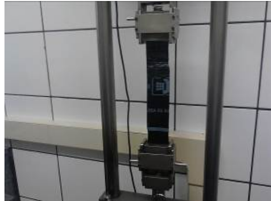
Imagem 4 - Manta sendo tracionada
