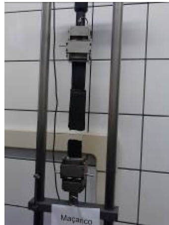
Imagem 5 - Manta após o ensaio de tração
