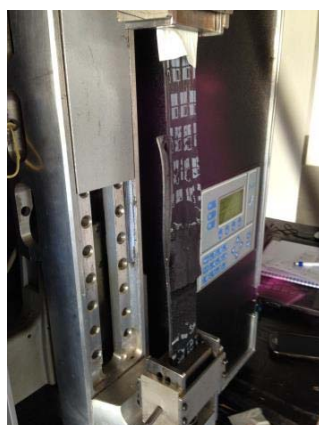
7- Execução do ensaio - Resistência à tração na emenda
