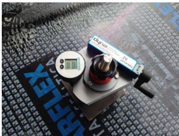
9- Ensaio de resistência de aderência à tração
