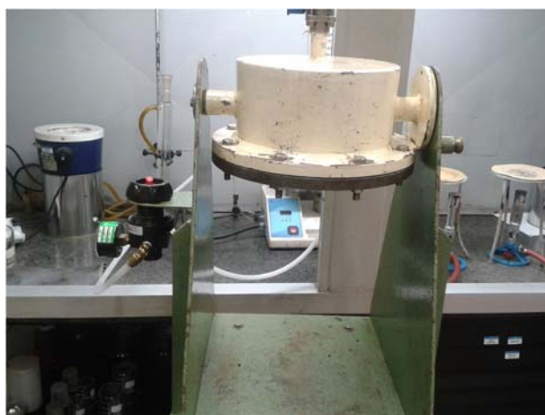
Foto 10: Equipamento de ensaio de estanqueidade
