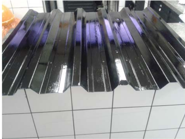
Foto 4: Modelo de telha metálica utilizada para os testes com primer aplicado
